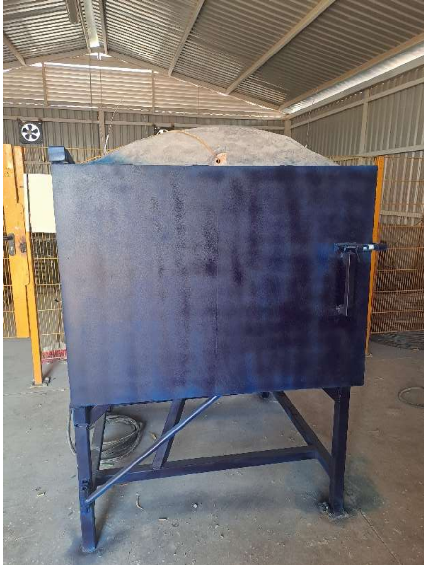
Figura 12. Vista frontal del horno de tratamiento térmico concluido y empleado en los ensayos experimentales.
