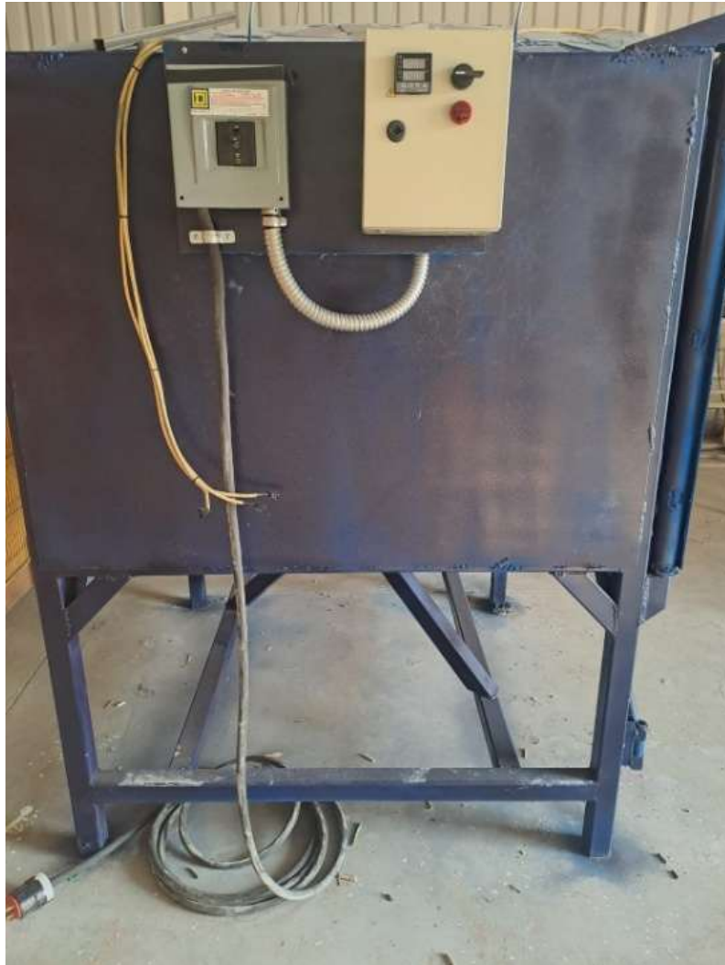
Figura 13. Sistema de control de temperatura empleado en las pruebas experimentales.
